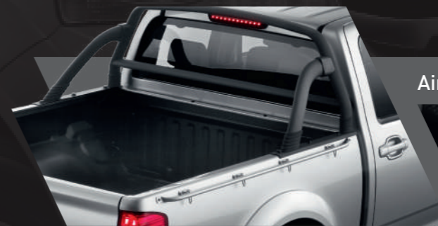
Tolva con protección revestida
